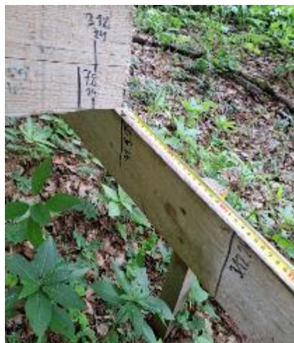
Slika 9: Pogled na spremljanje pomikov na odlomnem robu na zahodnem boku plazu Bistričica. Povprečni premik cca. 4,5 cm/mesec. Deformacije se pojavljajo tudi okrog točke spremljanja pomikov. Točka ni več zanesljiva.
