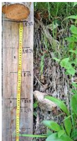
Slika 8: Prikaz hitrosti premikov na žičnem ekstenziometru preko zahodnega bočnega odlomnega roba plazu Bistričica – zgornji del. Povprečni premik v zadnjem obdobju 2,6 cm/mesec.
